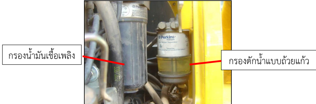
รูปที่ ๔-๗ กรองดักน้ำ และกรองน้ำมันเชื้อเพลิง
