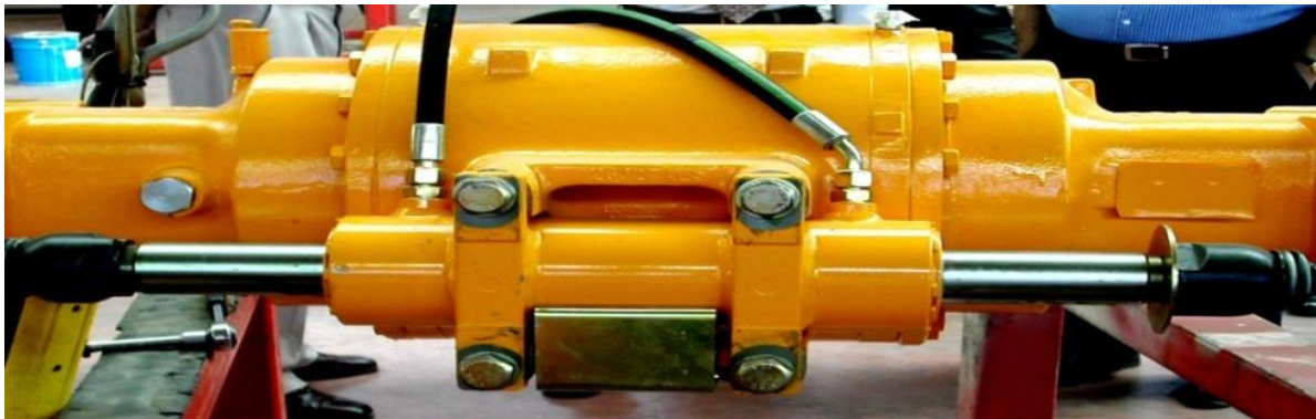
รูปที่ ๔-๓๐ กระบอกไฮดรอลิคบังคับเลี้ยวติดกับชุดเพลาชับ
