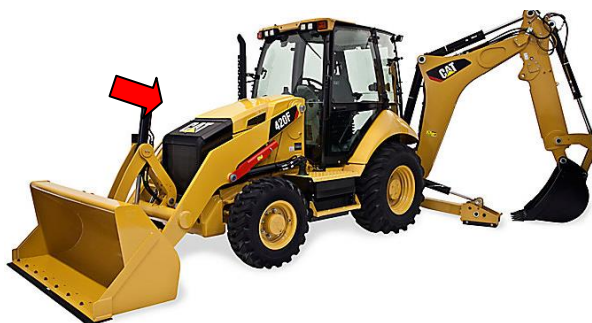
รูปที่ ๔-๔๓ กระบอกลไฮดรอลิกควบคุมการตกเทแบบกระบอกลเดียวของแคตเตอร์พิลลาร์
