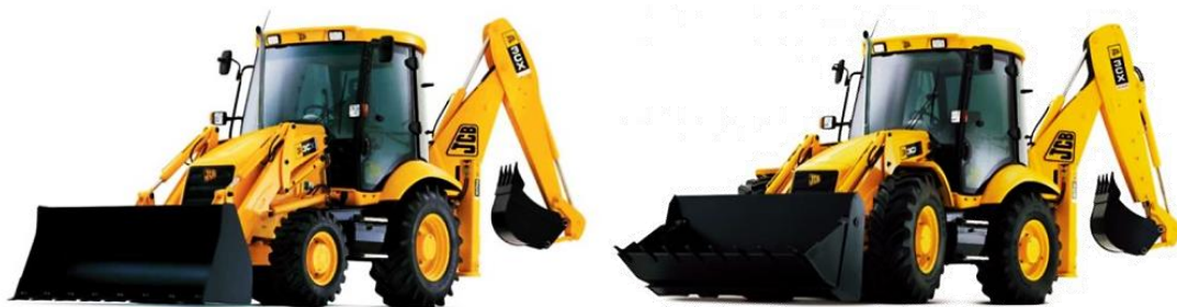
รูปที่ ๑-๑๒ เปรียบเทียบขนาดของยางรถ เจซีบี รุ่น ๓CX (ซ้าย) และ ๔CX (ขวา)
