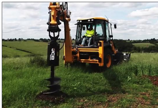
รูปที่ ๒-๙ การติดอุปกรณ์เสริมแทนบู๊ทที่หลัง สำหรับเจาะหลุม
