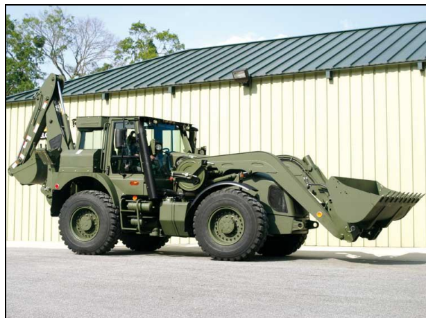
รูปที่ ๑-๑๐ รถดักหน้า-ชุดหลังสำหรับใช้งานทางทหารที่วิ่งได้เร็วที่สุดในโลกยี่ห้อ JCB รุ่นHMEE
