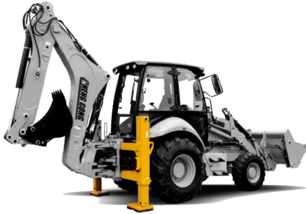
รูปที่ ๔-๕๐ ขาข้างแบบยัดวางกดลงบนพื้น
