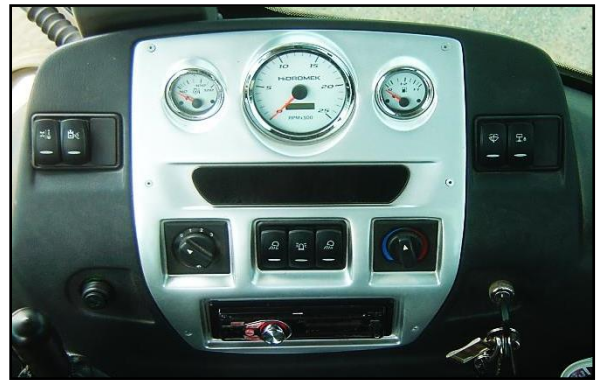
รูปที่ ๔-๒๕ สวิตช์ มาตรฐานและสัญญาณเตือนที่ชุดแผงคอนโซลและคันบังคับควบคุมด้านข้างขวา
