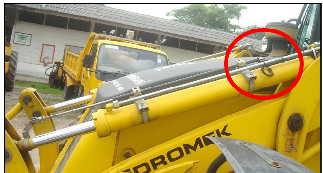
รูปที่ ๗-๓ อุปกรณ์แสดงระดับปุ่มกึ่งถูกติดตั้งไว้ที่แขนขุดขุดหน้า
