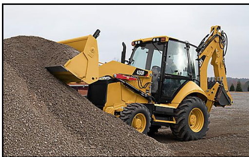
รูปที่ ๔.๓๔ บั้งกี้แบบพิเศษ ๖in๑ เปิดส่วนที่ใช้ตักออกทำให้สามารถใช้งานแบบไบนารีทรังก์เตอร์ดินตะขាប់ได้
