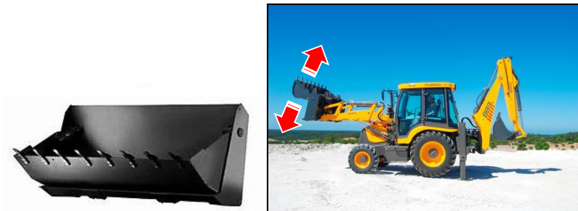
รูปที่ ๔.๓๔ บั้งกี้แบบพิเศษ ๖in๑ เปิดส่วนที่ใช้ตักออกทำให้สามารถใช้งานแบบไบนารีทรังก์เตอร์ดินตะขាប់ได้
