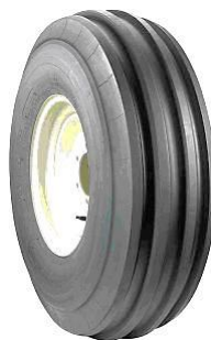
รูปที่ ๔-๑๗ ยางสำหรับพื้นโคลนและดินอ่อนนุ่ม ใช้กับล้อหน้าขนาดเล็กที่ไม่ขับเคลื่อน
