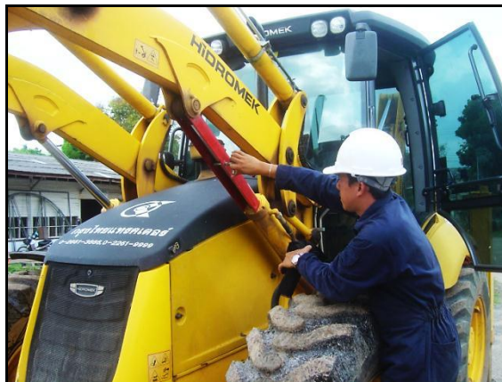
รูปที่ ๕.๑๐ การใส่ตัวค้ำยันที่กระบอกไฮดรอลิกยกบู๊ทหน้า
