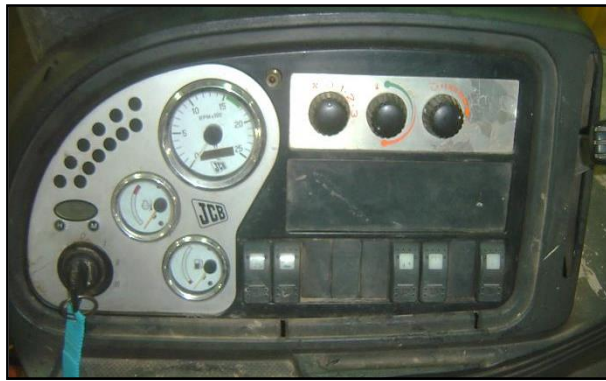
รูปที่ ๔-๒๕ สวิตช์ มาตรฐานและสัญญาณเตือนที่ชุดแผงคอนโซลและคันบังคับควบคุมด้านข้างขวา
