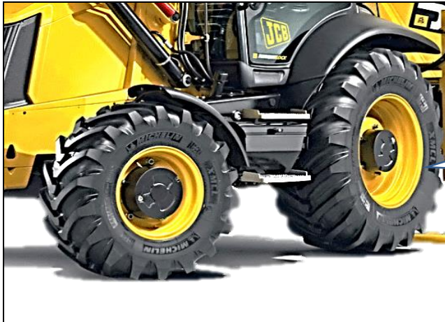
รูปที่ ๔-๑๕ ชนิดและขนาดของยางดูได้จากแก้มยาง
