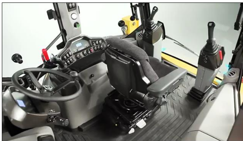
รูปที่ ๗-๑๐ คันบังคับชุดชุดหลังแบบจอยสติค (Joint Stick) ของรถตัดหญ้า ชุดหลัง Volvo รุ่น BL๖๑B, BL๗๑B
