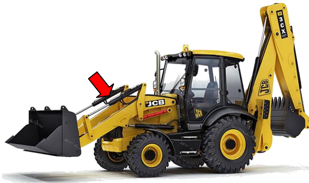
รูปที่ ๔-๔๒ กระบอกลไฮดรอลิกควบคุมการตกเทแบบคู่ขนานของ เจซีบี
