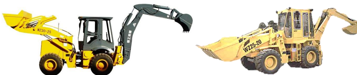
รูปที่ ๔-๒๘ รถดักหน้า-ชุดหลังที่ใช้ระบบบังคับเลี้ยวแบบหักกลางลำตัว
