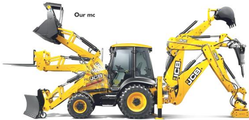
รูปที่ ๑-๙ การนำอุปกรณ์การทำงานหลายๆแบบติดตั้งกับรถตักหน้า-ขุดหลัง
