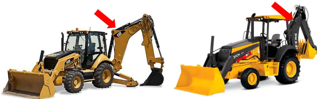
รูปที่ ๑-๔ รถดักหน้า-ขุดหลังยี่ห้อ Caterpillar และ John deere ที่ออกแบบให้บูมมีลักษณะโค้ง
