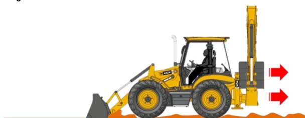
รูปที่ ๗-๒๔ การปรับพื้นที่โดยให้เครื่องจักรถอยหลัง
