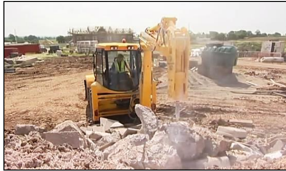
รูปที่ ๒-๘ การติดหัวกระแทกแทนบู๊ทที่หลัง
