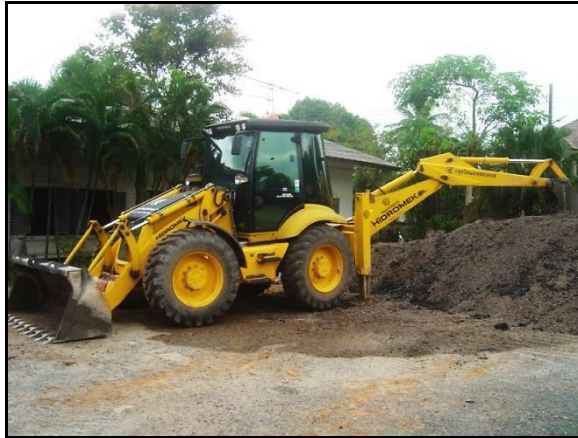
รูปที่ ๗-๑๗ การเคลื่อนย้ายบนถนนแบบให้ชุดขุดหลังขนานกับด้านหลังเครื่องจักร
