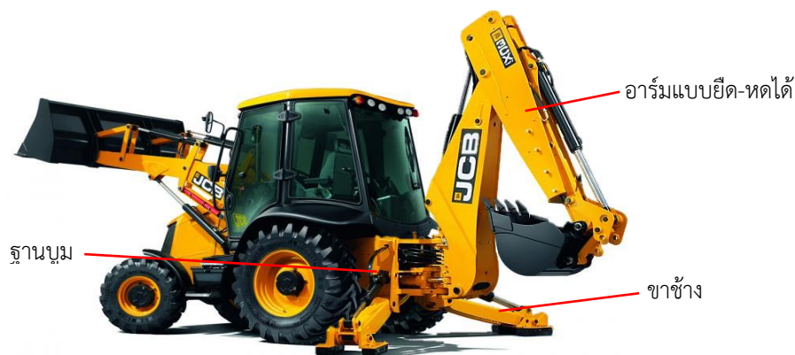
รูปที่ ๔-๔๕ ขุดขุดหลังแบบจุดหมุนยึดติดตรงกลาง (Center Pivot Type)
