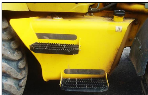
รูปที่ ๔-๖ ถังน้ำมันเชื้อเพลิงด้านขวาของเครื่องจักร
